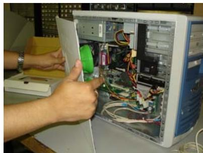
10. Colocar la antena como aparece en la figura y seguidamente proceder a la instalación del controlador (CD), ver Instrucciones para la Configuración de Tarjeta PCI.
