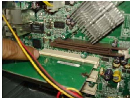
9. Una vez que ya quedo colocada la tarjeta, deberá a poner los seguros y colocar la tapa, asegurando bien los tornillos.
